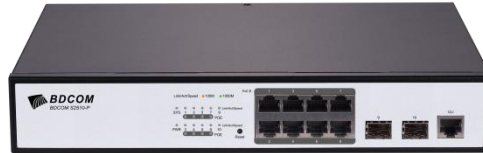
Gambar 2.2 Contoh switch BDCOM yang digunakan pada pelanggan
