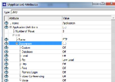
Gambar 4 Pengaturan aplikasi FTP pada *Application Config*
