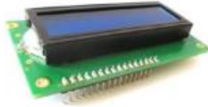
Gambar 2.7 LCD 16x2 Display [23].
