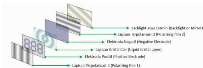
Gambar 2.6 Struktur Dasar LCD [20].
