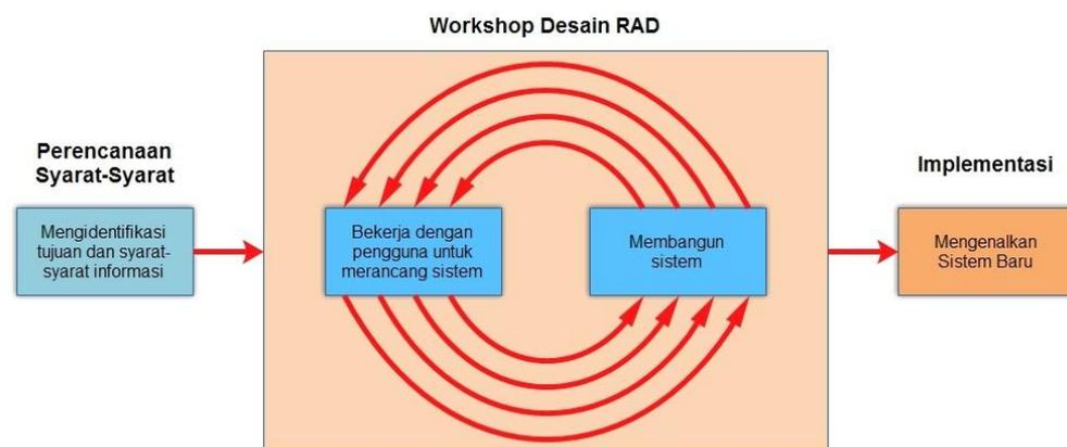
**Gambar 2.1** Tahapan-tahapan RAD.
