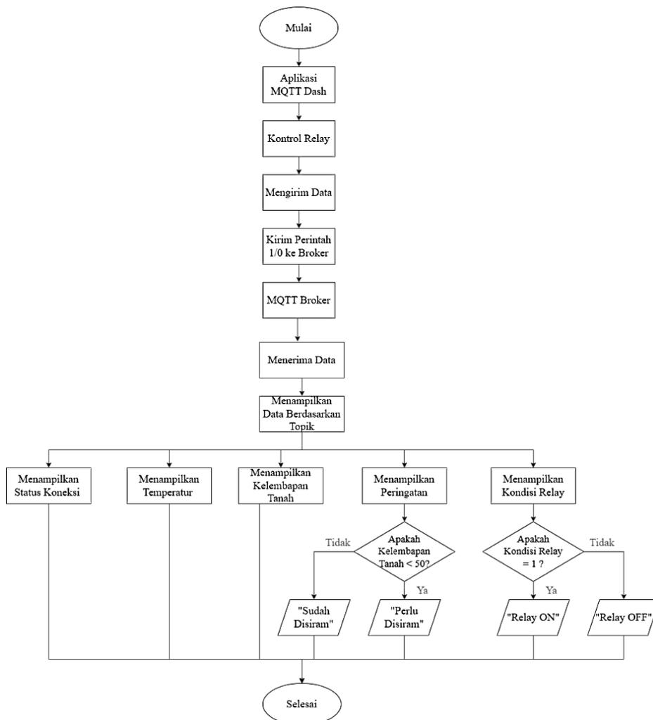
Gambar 3. 13 *Flowchart* Sistem pada MQTT *Broker*
