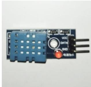
Gambar 2. 3 Sensor DHT 11
