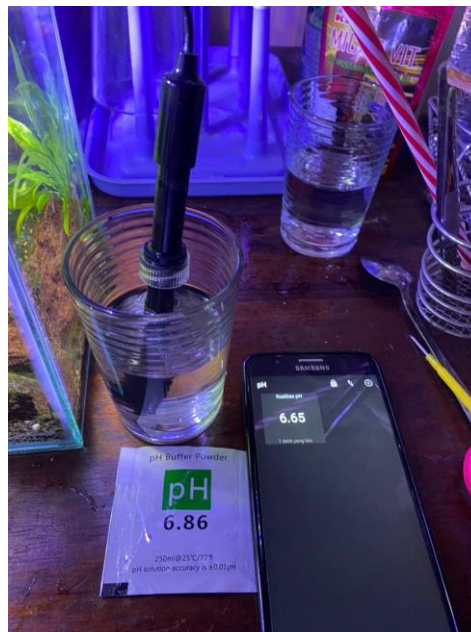
Gambar 3. 10 kalibrasi keakuratan pH meter dengan sensor pH
