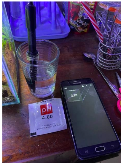
Gambar 3. 12 kalibrasi keakuratan pH meter dengan sensor pH
