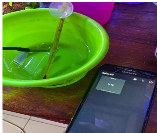
Gambar 3. 6 Pengujian keakuratan termometer dengan sensor suhu
