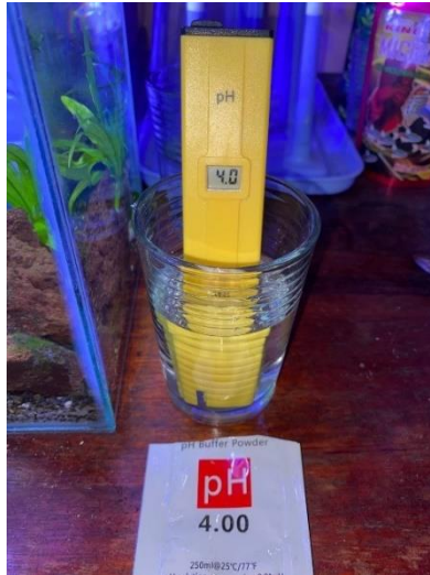
Gambar 3. 11 Hasil kalibrasi pH meter pada nilai ph 4.00
