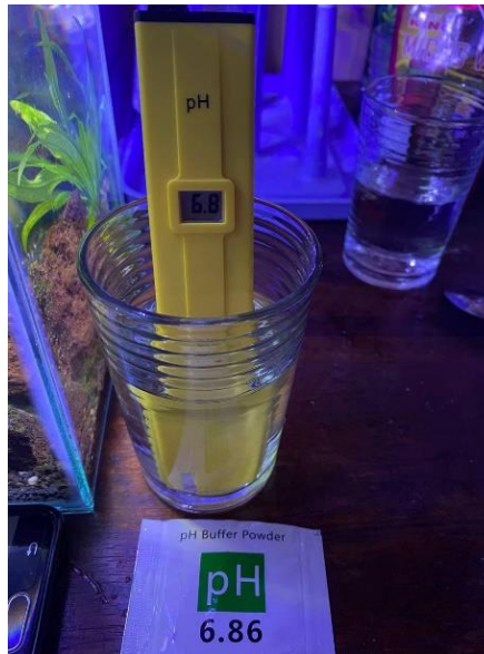
Gambar 3. 9 Hasil kalibrasi pH meter untuk nilai pH 6.86
