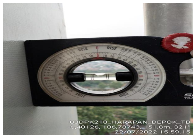
Gambar 3.16 Mengukur sudut elevasi dengan angle meter
