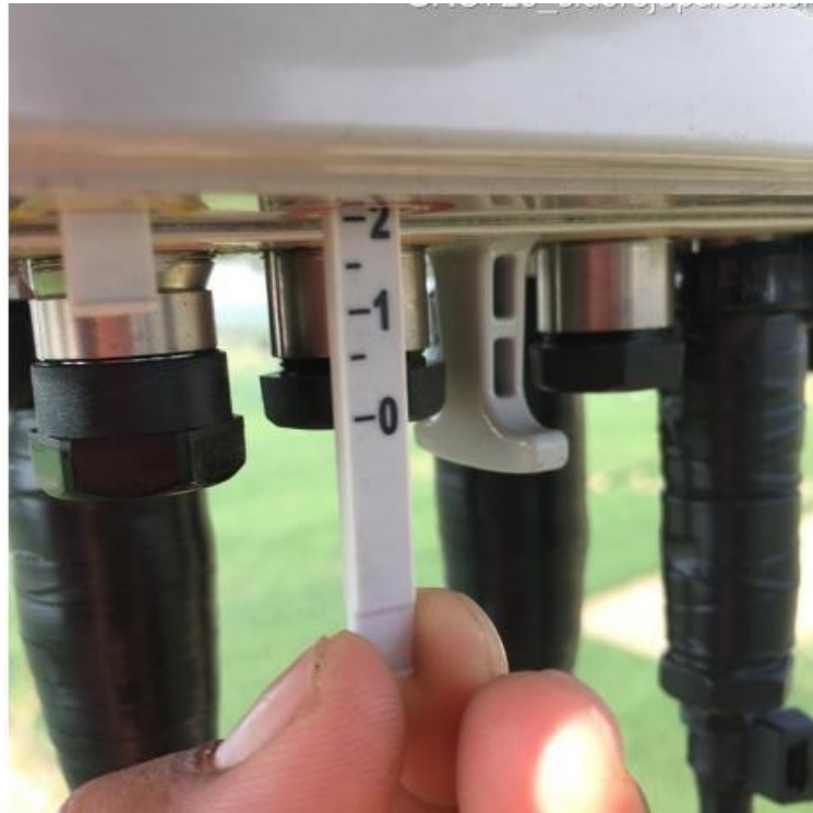
Gambar 3.15 Sudut elevasi dari antenna
