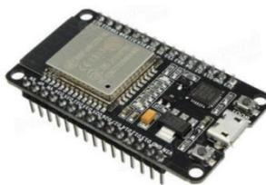
Gambar 3. 5 Mikrokontroller ESP32
