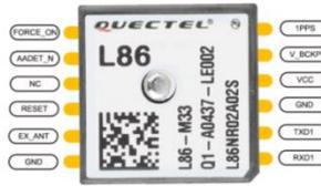
Gambar 3. 10 Konfigurasi Pin Modul GPS Quectel L86-M33
