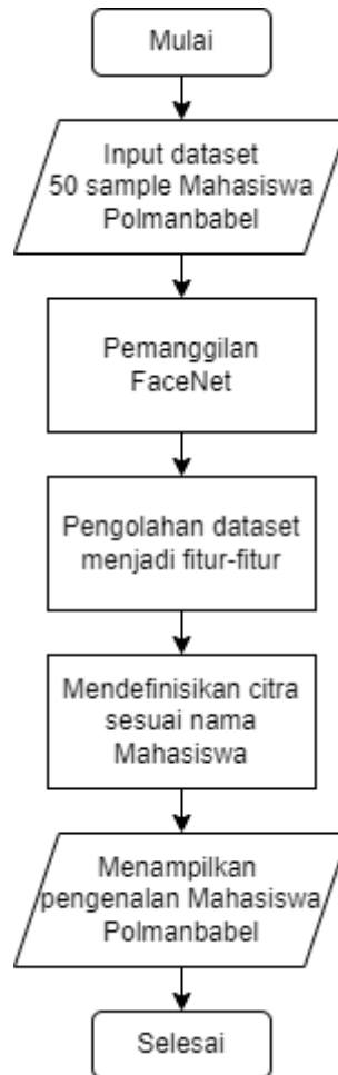
Gambar 3. 3 Diagram Perancangan Sistem
