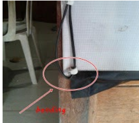
Gambar 2.11. Bending Serat Optik
