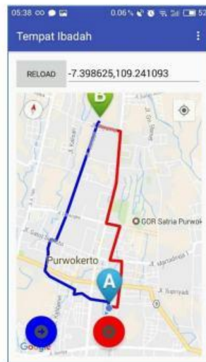
Gambar 6. Halaman rute menuju tempat ibadah (rute berwarna merah menggunakan Algoritma Dijkstra dan rute berwarna biru menggunakan Google Direction)
