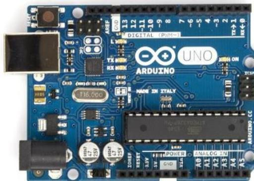
Gambar 2.13 Mikrokontroler (Atmega328)
