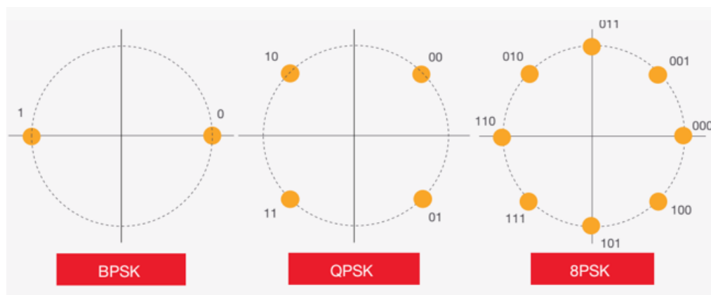
Gambar 2.22 Diagram Konstelasi Modulasi Digital[16]
