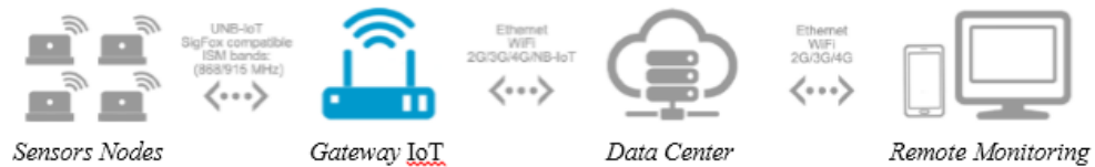
Gambar 2.2 FOG Computing NB-IoT[9]
