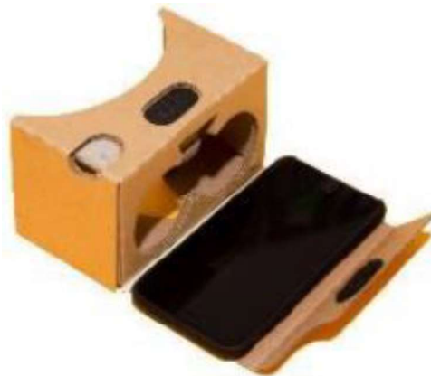
Gambar 2.1. Konstruksi Google Cardboard [2].
