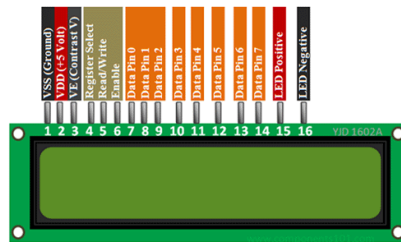
Gambar 2. 11 Lcd 16x2 Dan Pin Out
