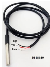
Gambar 2. 4 Sensor Suhu DS18B20[17]
