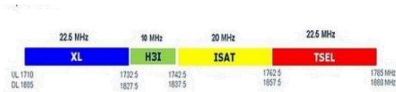
Gambar 2.3 Kanal empat operator seluler di frekuensi 1800 MHz sesudah ditata ulang [6]
