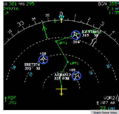
Gambar 2. 16 Tampilan monitor CDTI cockpit pesawat yang dilengkapi dengan ADS-B dengan fungsi Ground Based ADS-B Airport Surveillance Situation Awareness [23].
