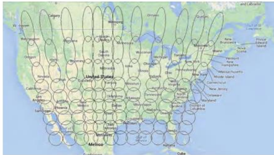
Gambar 2.5 footprint spot beams pada sistem HTS [5]
