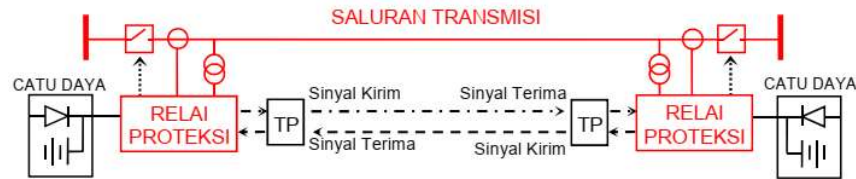
Gambar 2.2 Typical Komponen Sistem Proteksi SUTT.[1]
