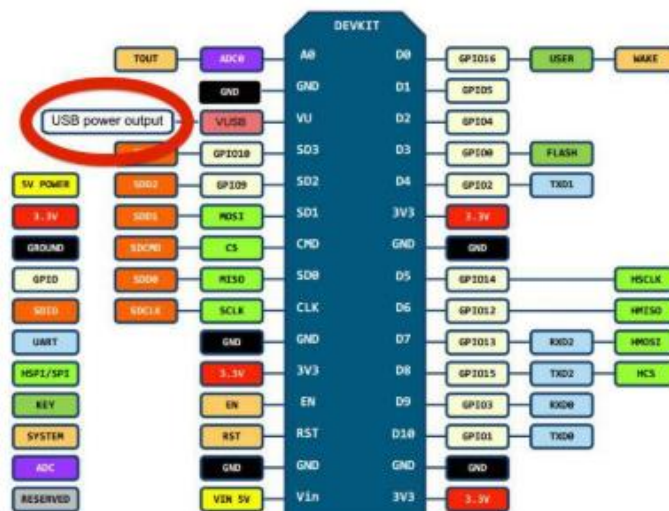
Gambar 2.3 Skematik posisi Pin NodeMcu Dev Kit v3[12]
