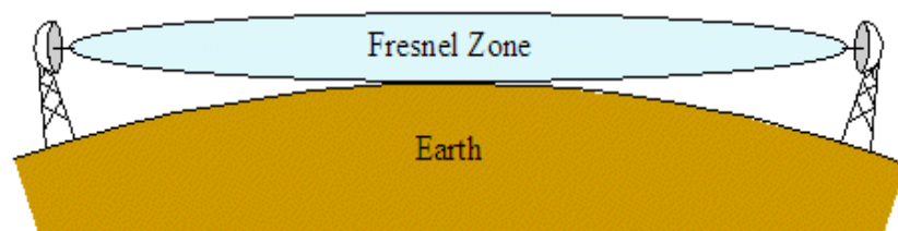
Gambar 2.8 Fresnel Zone pada Transmisi Microwave
