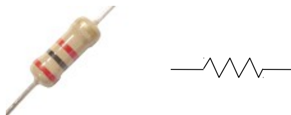
Gambar 2.17 Bentuk Resistor Tetap dan Simbol Resistor
