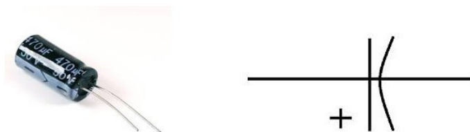
Gambar 2.16 Kapasitor elektrolit dan simbolnya.
