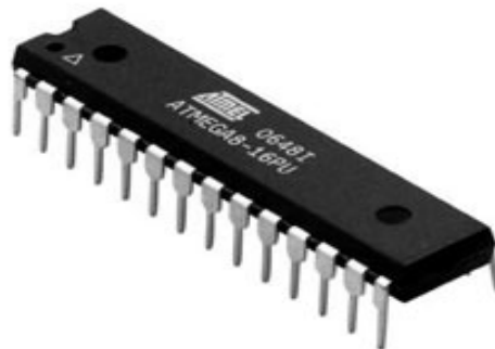
Gambar 2.4. Bentuk fisik ATMega 8 [4] .
