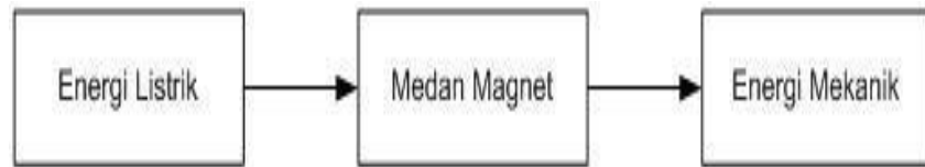
Gambar 2.5 Proses Konversi Energi pada Motor DC [2]
