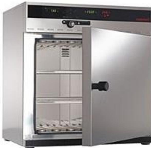
**Gambar 2. 6 Alat Uji Ketahanan Suhu**
