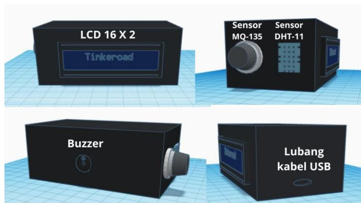
**Gambar 3.5 Desain 3D *casing* alat tampak dari tiga sisi yang berbeda**
