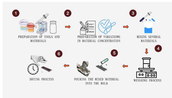
Gambar 3.2 Ilustrasi Proses Optimasi Konsentrasi Material Silicone
