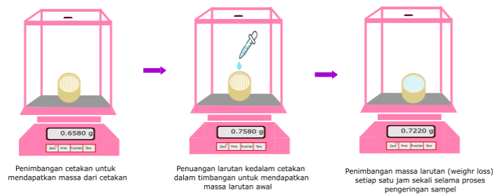
Gambar 3.11 Metode Pengukuran Perubahan Massa Larutan
