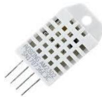
Gambar 3. Sensor Kelembapan DHT22
