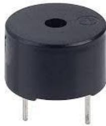
Gambar 2. 1 Bentuk Buzzer [28].
