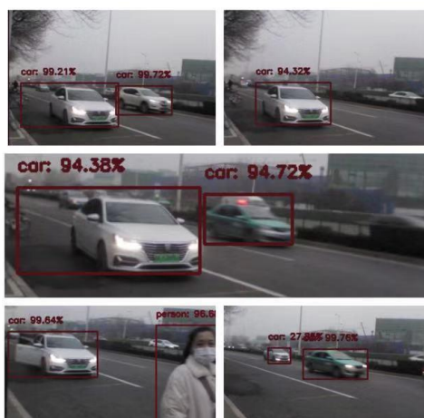
Gambar 2.3 Real-time detection menggunakan SSD [28]
