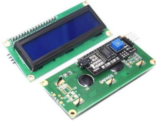
Gambar 2.3 Liquid Crystal Display 16x2 dan I2C [17]
