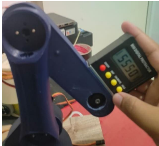
Gambar 4.6 Hasil Pengukuran Servo Elbow Pada Alat sudut 140°
