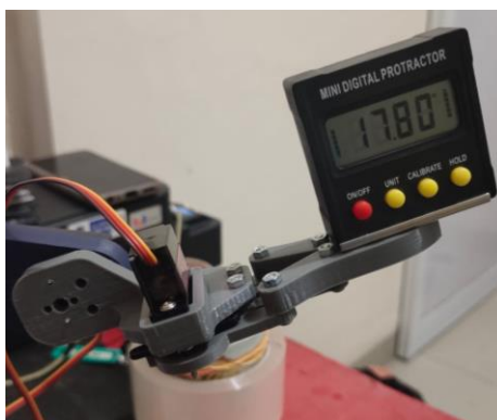
Gambar 4.7 Hasil Pengukuran Servo Wrist Pada Sudut 120°
