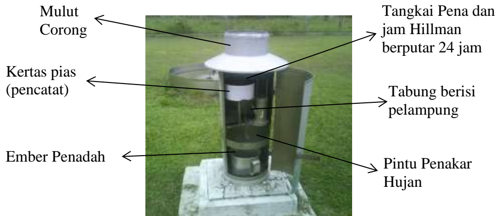
Gambar 2.7 Bagian Dalam Dari Alat Penakar Hujan Otomatis Tipe Hellman
