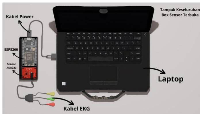
Gambar 3.3 sistem tampak keseluruhan *box* sensor terbuka
