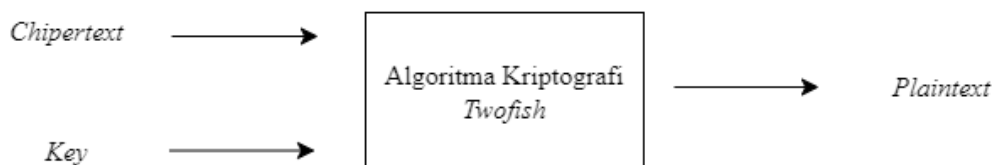
Gambar 2.7 Cara kerja sederhana dekripsi menggunakan twofish
