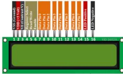
**Gambar 2.8 Bentuk Fisik LCD [19]**
