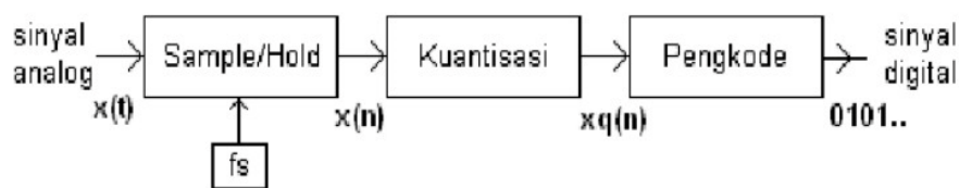
Gambar 2.9 Proses konversi sinyal analog menjadi sinyal digital [35].
