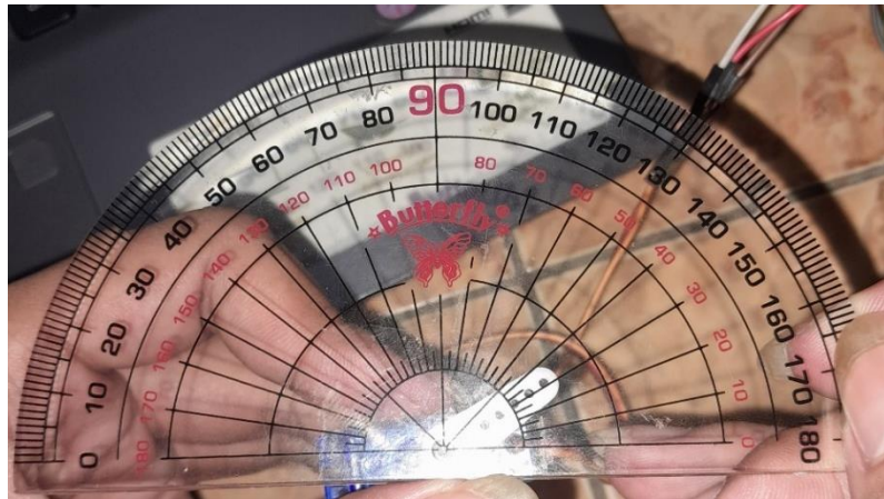
Gambar 3. 17 Pengujian 30° Pada Sudut Servo Menggunakan Busur
