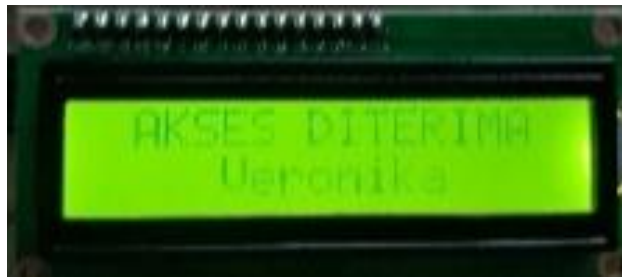
Gambar 3. 14 Output RFID Akses Diterima Pada LCD
