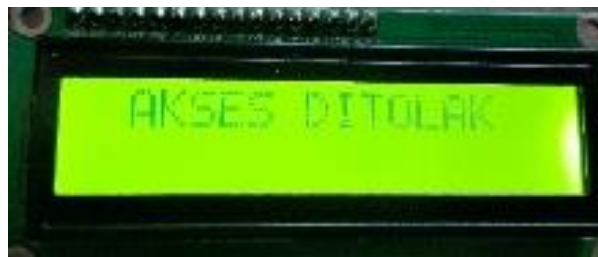
Gambar 3. 15 Output RFID Akses Ditolak Pada LCD
