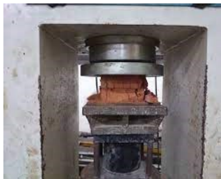
Gambar 3. 9 Proses Uji Kuat Tekan
