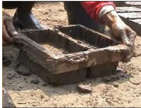
Gambar 3.2 Cetakan Batu Bata
