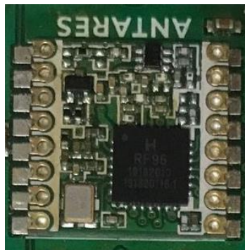
Gambar 2. 4 Modul LoRa RF96
