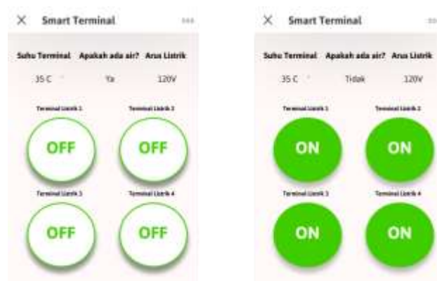
Gambar 3. 3 Pembuatan User Interface Sistem Kendali dan Monitoring Terminal Listrik dengan platform Blynk
