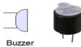
Gambar 2.10 Simbol dan bentuk buzzer [37]
