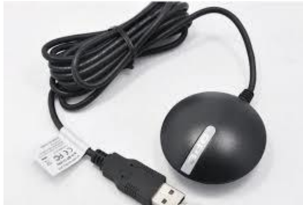
Gambar 2.10 Perangkat GPS ( Global Positioning System )[18].
