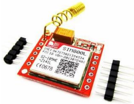
Gambar 2.7 Modul GSM SIM800L
