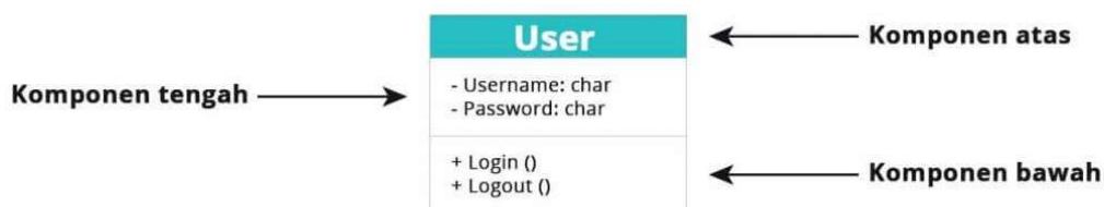
Gambar 2.7 Komponen Dari Class Diagram [28].
