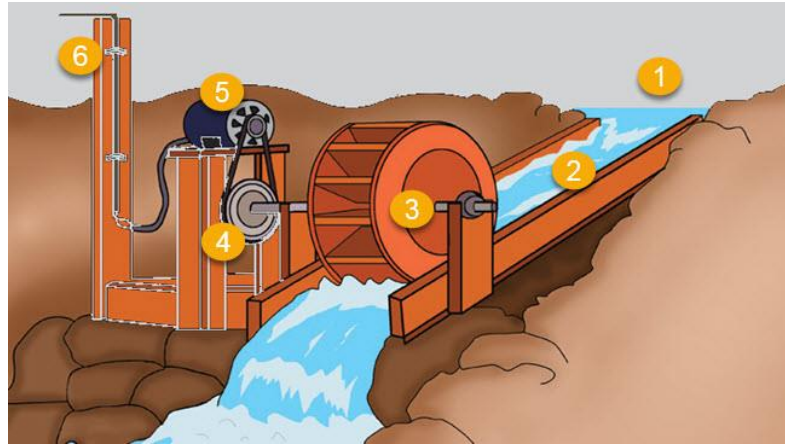
Gambar 2. 1 Pembangkit Listrik Tenaga Mikrohidro
